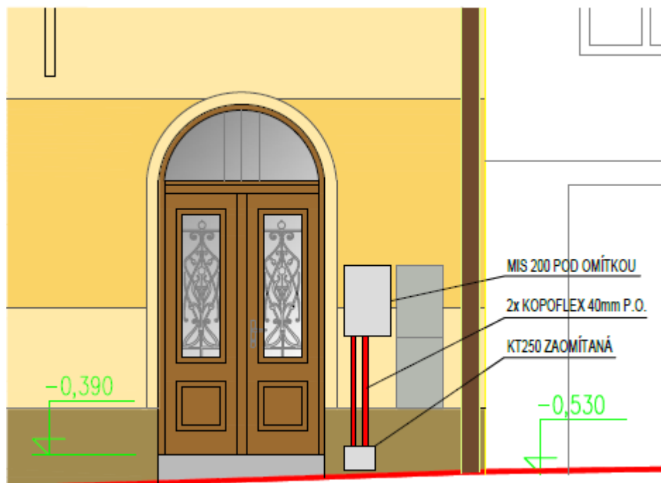
Obr.2 – osazení opt.rozvodnice - rezerva
